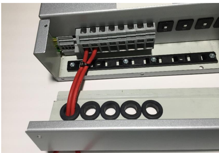
Abbildung 8: Leitung mit Kabelbinder an der Zugentlastung gesichert
