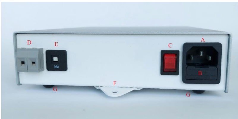
Abbildung 1: Übersicht über die Spannungsversorgung für „CeT Power 350“
