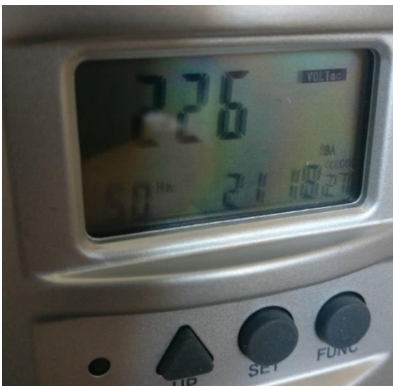
Abbildung 2: Anzeige „VOLTac“ Ablesung der Netzspannung
