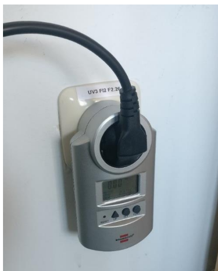
Abbildung 1: Leistungsmessgerät in Steckdose, mit angeschlossenem Netzteil
