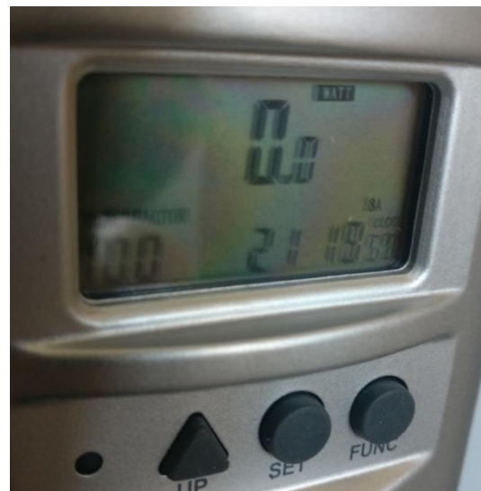
Abbildung 3: Anzeige „WATT“ Ablesung der Leistung (0W = nichts angeschlossen oder Netzteil aus)
